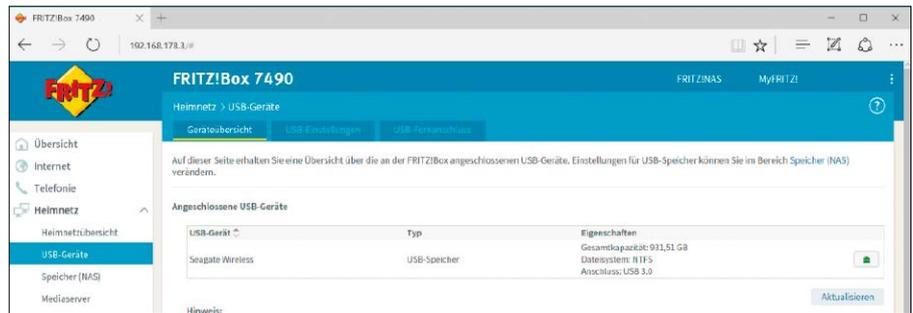
USB-Festplatte: Am schnellen USB-3.0-Port aktueller Fritzbox-Modelle schließen Sie externe Festplatten und USB-Sticks an, die danach als zusätzlicher Speicher für die FritzNAS zur Verfügung stehen.
