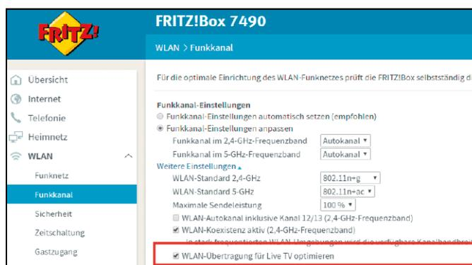
Bei der Fritzbox ganz einfach: Die AVM-Router verfügen über eine Menüeinstellung, um die Übertragung von IPTV zu optimieren.
