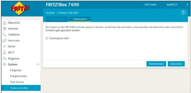
Bei der Fritzbox lassen sich im Routermenü die Tasten sperren. Dann kann niemand mehr absichtlich oder unabsichtlich WLAN oder DECT abschalten.
