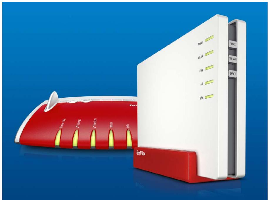
Frequenz 2,4 GHz unterwegs, sinkt die Datenrate: Der Router kann die einzelnen Verbindungen nur nacheinander abarbeiten, die Gegenstellen müssen also warten, bis sie mit ihrer Datenübertragung dran sind. Das kann vor allem bei Verbindungen, die wie etwa beim Video-Streaming auf einen konstanten Datenstrom angewiesen sind, zu Rucklern oder Abbrüchen führen.
